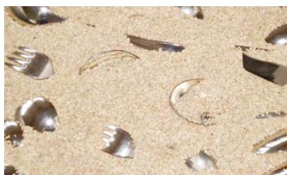
**2** Qui passano, attraverso una salita a spirale, un granulato di lucidatura caldo di alta qualità.
