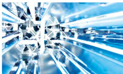
**3** Les granules de polissage et la surface des couverts sont continuellement stérilisés par lumière UVC.
