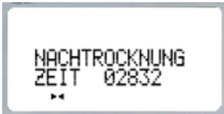
Sobald für 2 Minuten kein Besteck in die Maschine eingeworfen wird, beginnt die Nachrocknungszeit über 30 Minuten. In der zweiten Zeile wird die verbleibende Zeit angezeigt. z.B. hier: 28 Minuten und 32 Sekunden. Nach diesen 30 Minuten schaltet sich die Maschine automatisch aus. Sie brauchen dann nur noch den Hauptschalter [ (1) grün ] ON/OFF zu drücken, um die Maschine komplett auszuschalten und vom Strom zu nehmen.
