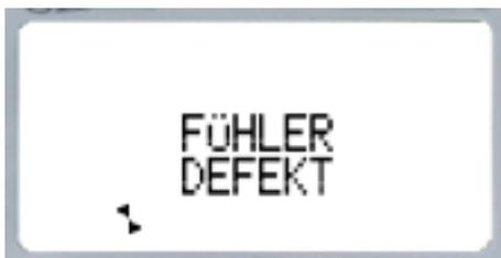
Diese Fehlermeldung erscheint z.B. direkt nach dem Systemtest oder während des Betriebs, wenn der Temperaturfühler defekt ist, begleitet von mehreren kurzen Signaltönen.
