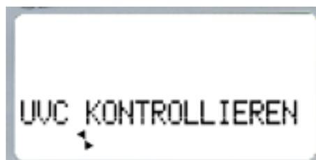
Diese Fehlermeldung erscheint z.B. direkt nach dem Systemtest oder während des Betriebs, wenn die UVC-Lampe entweder verschmutzt oder defekt ist, begleitet von mehreren kurzen Signaltönen.
