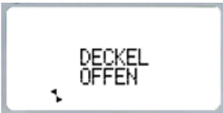
Sollte der Deckel der Besteckpoliermaschine während des Betriebs geöffnet werden, schaltet sich diese aus Sicherheitsgründen aus. Die UVC-Strahlung wäre zu gefährlich für Augen und Haut.
