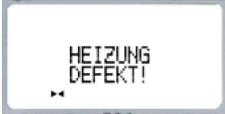
Diese Fehlermeldung erscheint wenn die Heizung defekt ist, gefolgt von mehreren kurzen Signaltönen.
