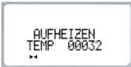
Sobald der Systemtest ohne Fehlermeldungen ausgeführt worden ist, beginnt die Aufheizphase. In dieser Wartezeit, wird das Granulat auf eine Temperatur von 80 °C erwärmt.
