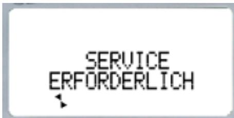
Die Maschine läuft zwar weiterhin weiter, jedoch wird keine andere Meldung mehr angezeigt. Diese Meldung bleibt konstant stehen bis ein Techniker das Service vornimmt.
