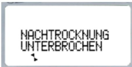
Sobald die Maschine in der Nachrocknungszeit ausgeschaltet wird oder während des Poliervorgangs der Deckel geöffnet wird oder die Maschine ausgeschaltet wird, erscheint diese Fehlermeldung, begleitet von mehreren kurzen Signaltönen.
