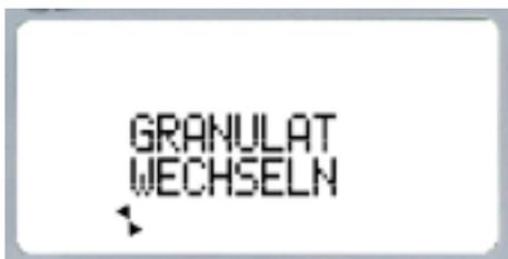
Nach 150 Betriebsstunden wird diese Meldung angezeigt und ein Poliergranulatwechsel muss vorgenommen werden, um ein optimales Polierergebnis garantieren zu können. Die Maschine läuft zwar weiterhin weiter, jedoch wird keine andere Meldung mehr angezeigt. Diese Meldung bleibt konstant stehen bis ein Poliergranulatwechsel vorgenommen wird.
