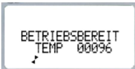
Wenn die 80 °C erreicht sind, erscheint die Meldung „BETRIEBSBEREIT“ begleitet von vier kurzen Signaltönen. In der zweiten Zeile steht für kurze Zeit die Temperatur, bis diese Zeile durch die Anzeige der Zeit ausgetauscht wird. In dieser Zeitangabe ist auch die Aufheizphase inkludiert. Sollte nach insgesamt 30 Minuten kein Poliervorgang stattfinden, schaltet sich die Maschine automatisch aus. Die Stromversorgung bleibt weiterhin bestehen.
